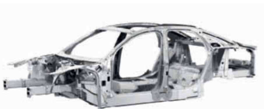
Die Audi Space Frame Technologie spart bis zu 40 Prozent des Karosseriegewichts.
