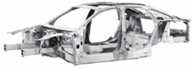
Die Audi Space Frame Technologie spart bis zu 40 Prozent des Karosseriegewichts.
