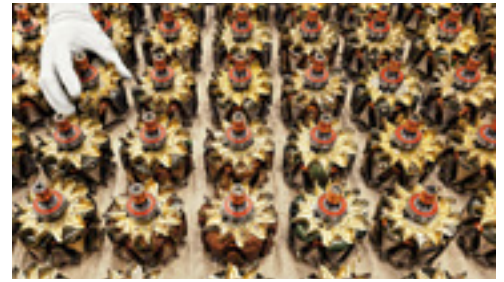
Aggregate-Aufbereitung: das zweite Leben für Lichtmaschinen und Anlasser.
