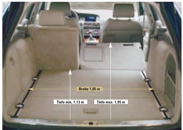
Geteilt: Die Rückbanklehne im Avant läßt sich asymmetrisch umlegen, ergibt aber leider keine ganz ebene Ladefläche (oben). Der V6 baut kurz und ist bärenstark (links)
