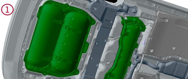
Absperrventile der Gastanks lokalisieren
