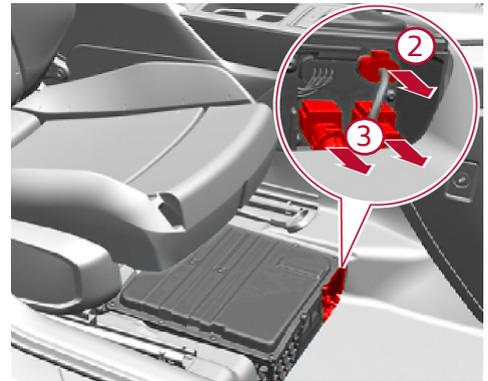
En cas d'accidents impliquant un déclenchement d'airbags, le réseau de bord 48 V est automatiquement désactivé.
