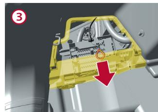
Prise de recharge à droite : procédure analogue à celle du côté gauche du véhicule (tirer la boucle jaune)
