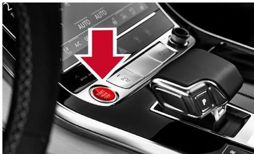
Accionar la tecla "Start-Engine-Stop" situada en la consola central sin accionar el pedal del freno.
