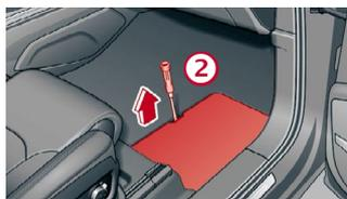
2. Levantar la cubierta de la batería.
