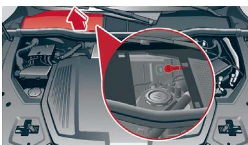
La batteria a 12 V si trova nella parte anteriore del veicolo, sotto la copertura della vaschetta di raccolta dell'acqua.
