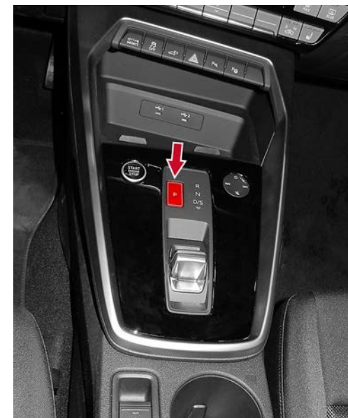
Véhicule avec boîte de vitesses automatique sans levier sélecteur : appuyer sur la touche « P »
