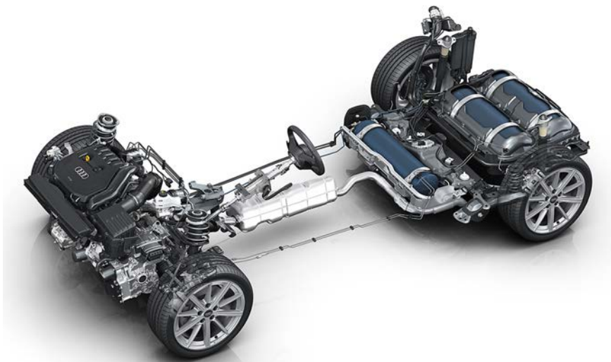
Audi A3 g-tron avec 3 réservoirs de gaz
