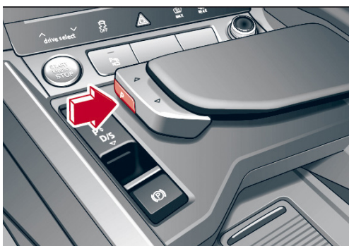
Véhicule avec boîte de vitesses automatique sans levier sélecteur : appuyer sur la touche « P »
