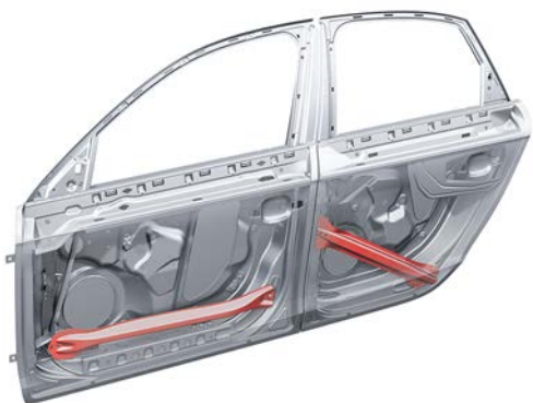
Protection anticollision latérale dans les portes
