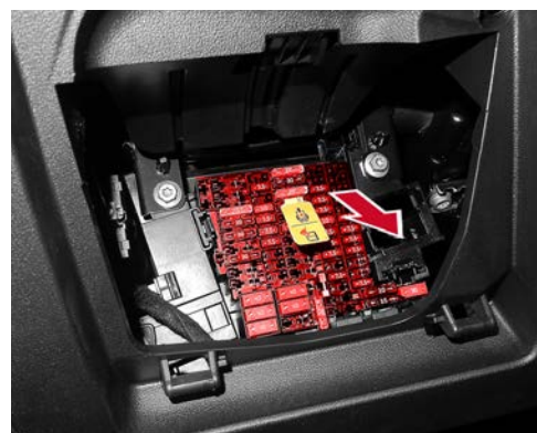
Dispositif de déconnexion dans le compartiment passagers, tableau de bord sur le porte-fusibles
