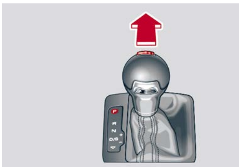
Véhicule avec boîte de vitesses automatique avec levier sélecteur : mettre le levier sélecteur sur la position « P »
