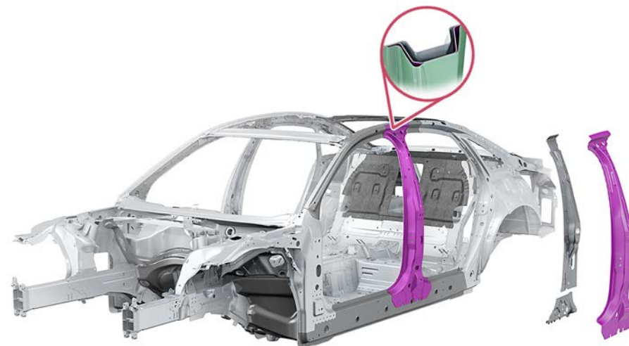
Montant B avec structure multicouche
